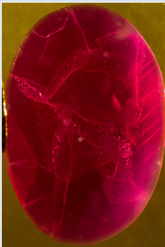
Fig. 37-38-39-40 Rubini DourCoat con veli concoidi e incrociati. Nella parte destra delle pietre linee parallele di accrescimento dei cristalli tabulari.
