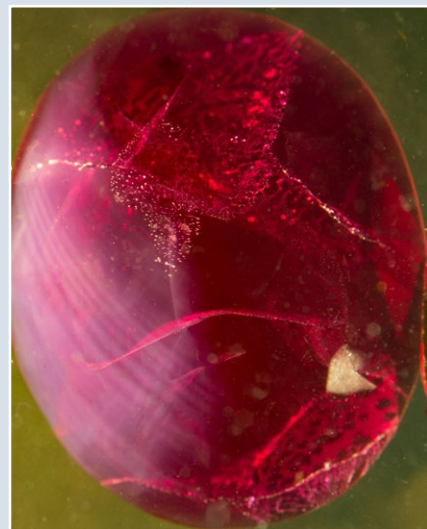
Fig. 44 Striature curvilinee, microfrazture a ginocchio di varie forme con disegno poligonale e bolle di fondente.
