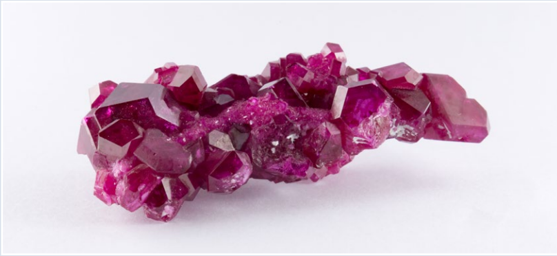
Fig. 13 Aggregato cristallino di DourChat. I tempi di cristallizzazione sono lunghi, variano da due a tre mesi, ad una temperatura costante che si aggira intorno ai 1300° a pressione atmosferica. La difficoltà incontrata dai fratelli Douros per la produzione di rubini perfetti e in modo costante era dovuta alla rudimentale tecnologia dei forni elettrici con scarsa coibenza, con i quali non era facile mantenere una temperatura costante, peraltro fondamentale per una crescita perfetta dei cristalli, soprattutto di grandi dimensioni.
