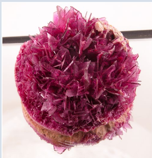
Fig. 7 Intero crogiuolo di rubino Douros di prima generazione nella fase iniziale di cristallizzazione. Come riportato in diversi studi, il rubino Douros di prima generazione nasce per nucleazione spontanea con il metodo da fondente "flux" (una miscela segreta di fondenti) in un crogiuolo di grafite (per motivi economici non venivano usati crogiuoli di platino). L'unico elemento distintivo rispetto agli altri procedimenti "flux" era la forte presenza di piombo (probabilmente i Douros usavano fluoruro e ossido di piombo) che serviva ad abbassare la temperatura di fusione dei componenti e la miscibilità tra loro.
