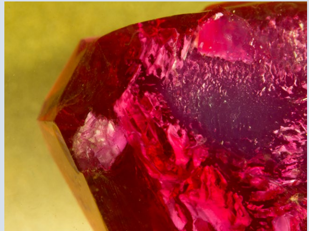
Fig. 19 Cristallo grezzo di DourChat. Ingrandimento della foto precedente che evidenzia il seme (frammento di corindone Verneuil).
