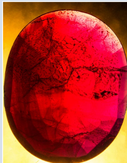
Fig. 35-36 Rubini DourCoat con inclusioni poligonali, veli con forma a ginocchio e incrociati, bolle di fondente.
