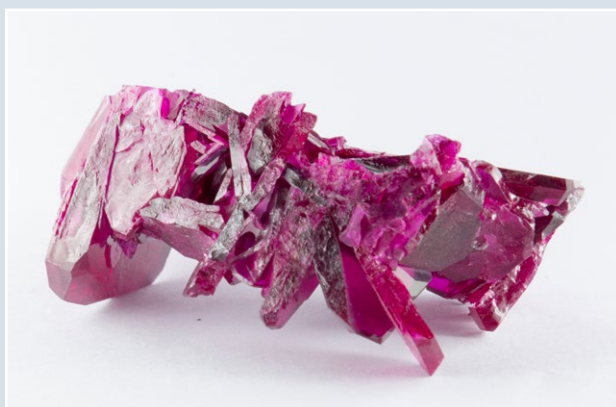
Fig. 10-11 Come si vede dalle foto, nella prima fase di crescita la forma romboedrica predomina in sottili cristalli intrecciati tra loro in modo non ordinato. A sinistra, cristalli esagonali in via di ingrossamento. A destra, cristalli esagonali appena formati.
