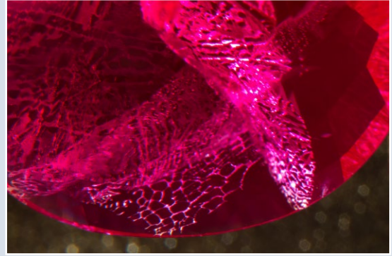
Fig. 29 Inclusioni miste con bande di colore.
