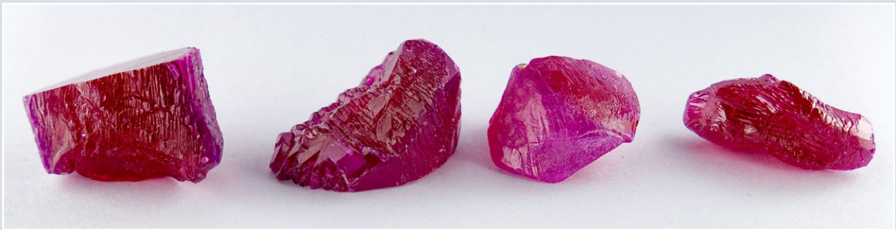
Fig. 31 Rubini sintetici Verneuil ricoperti con il metodo Douros, i DourCoat. La superficie irregolare è solcata da striature cristalline di forma tabulare allungata e accoppiata che ricoprono il grosso frammento di boule, in alcuni punti si osservano formazioni esagonali. Da notare che la crescita è quasi nulla sulle superfici segate mentre è normale su quelle da frattura.
