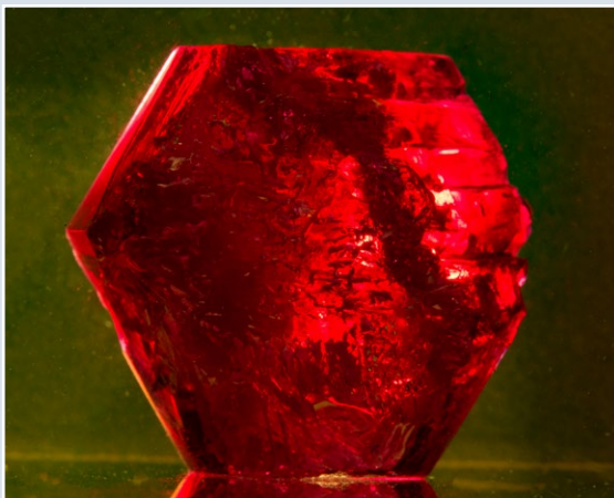
Fig. 14 Cristalli singoli di DourChat. La forma dei cristalli del grezzo cambia completamente rispetto ai precedenti di prima generazione, poiché diventano massicci e assumono forma tabulare di una bipyramide esagonale tronca (pentagonal bipyramid). L'aspetto dei cristalli è singolare, non ho trovato corrispondenze con il grezzo dei Chatham tradizionali, né con i Ramaura e neppure con gli Kniska: sarebbe interessante approfondirne l'aspetto cristallografico per valutarne le simmetrie di crescita. In natura cristalli simili sono riscontrabili nei giacimenti Burmesesi di Mogok, nei quali, oltre che prismi tabulari esagonali che oscillano tra la pinacoide basale e la piramide, si possono trovare anche i prismi con le facce romboedriche. Le tracce di flux che si riscontrano esternamente sui cristalli sono di colore bianco e non giallastro come nei primi Douros, questo significa che la sua composizione è variata e probabilmente non entrano più nella composizione dei composti piombici.
