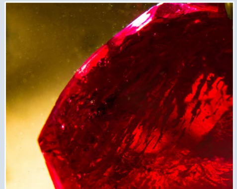
Fig. 20-21 A sinistra, altro cristallo seme di DourChat. A destra, inclusioni di fondente all'interno del cristallo grezzo di DourChat.
