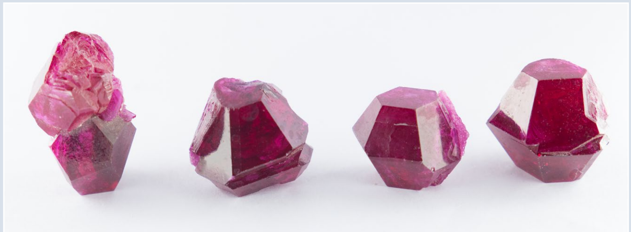
Fig. 14 Cristalli singoli di DourChat. La forma dei cristalli del grezzo cambia completamente rispetto ai precedenti di prima generazione, poiché diventano massicci e assumono forma tabulare di una bipyramide esagonale tronca (pentagonal bipyramid). L'aspetto dei cristalli è singolare, non ho trovato corrispondenze con il grezzo dei Chatham tradizionali, né con i Ramaura e neppure con gli Kniska: sarebbe interessante approfondirne l'aspetto cristallografico per valutarne le simmetrie di crescita. In natura cristalli simili sono riscontrabili nei giacimenti Burmesesi di Mogok, nei quali, oltre che prismi tabulari esagonali che oscillano tra la pinacoide basale e la piramide, si possono trovare anche i prismi con le facce romboedriche. Le tracce di flux che si riscontrano esternamente sui cristalli sono di colore bianco e non giallastro come nei primi Douros, questo significa che la sua composizione è variata e probabilmente non entrano più nella composizione dei composti piombici.
